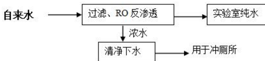
图 2-9 制纯水生产工艺流程及产污环节图
