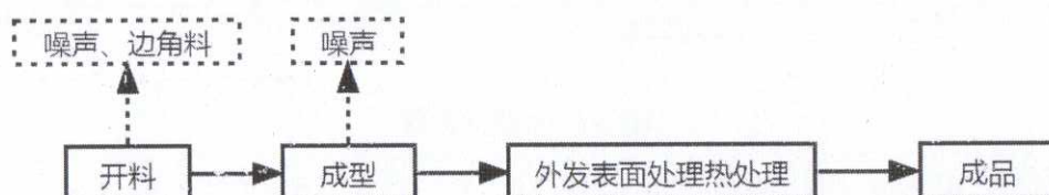
图 2-3 弹簧生产工艺流程图
