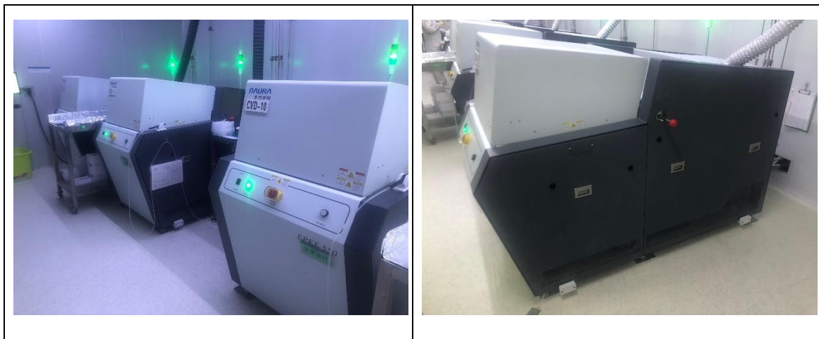
图 3.2-1 本验收项目生产设备图片（PECVD）
